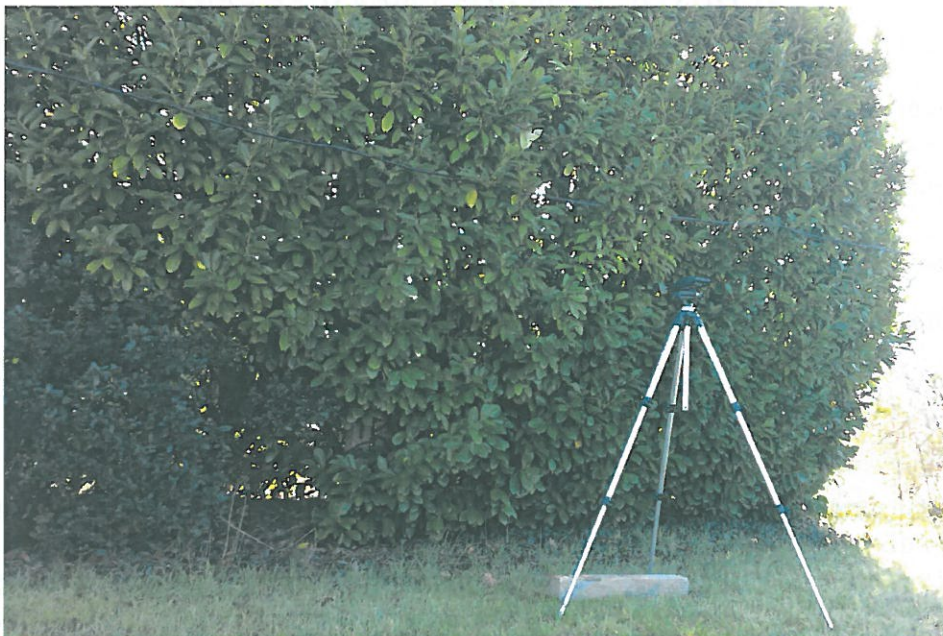
Fonometro posto di fronte alla siepe Sound level meter placed in front of the hedge
